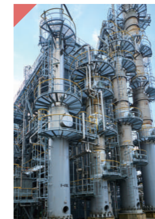
⑦ スタビライザーコラム 油をタンクローリーで安全に運搬できるように、加温し、蒸気圧力を調整します。
