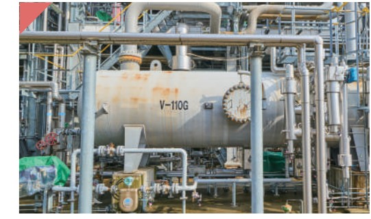
③ 高圧セパレータ 流体を天然ガス、油、水にそれぞれ分離させます。
