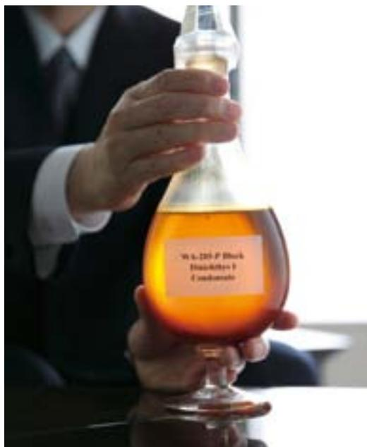
探鉱作業時にイクシスガス・コンデンセート田から産出したコンデンセート(実物)
