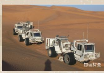
地質調査に加え、衛星画像、地震波による物理探査などを活用し、原油・天然ガス鉱床の存在可能性を調査します。さらに、その存在を確認するための井戸「試掘井」を掘削します。
