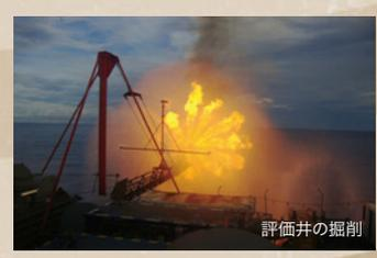
原油・天然ガスの存在が確認された場合、油・ガス田の広がり进行调查するための「評価井」を掘削し、埋蔵量を評価します。さらに、採算性の検討など、商業生産の可否を判断します。
