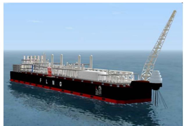
FLNG イメージ図 Hull Size: 500m length × 82m width
