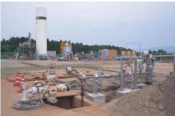
(財)地球環境産業技術研究機構と協力し、『二酸化炭素地中貯留技術研究開発』を行っております。本研究では、二酸化炭素を圧入・固定する場所として、新潟県長岡市の郊外で地下約千メートルの帯水層が選定され研究開発が行われています。
